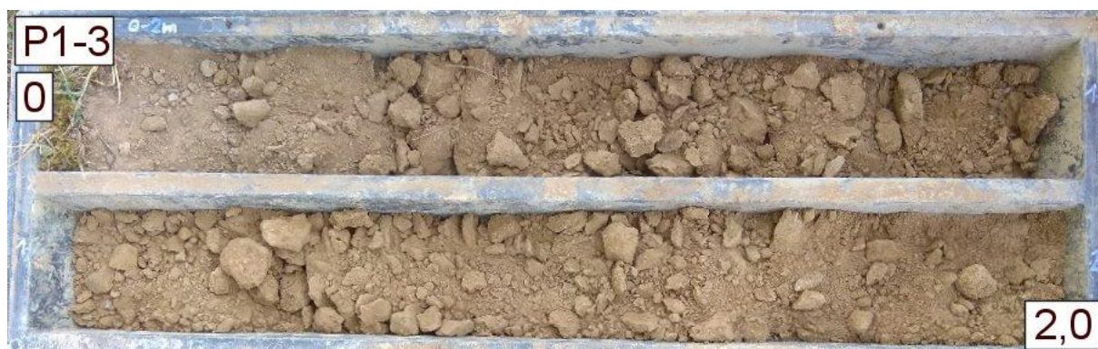
Obrázek č. 3 Sonda P1-3: 0,0 – 2,0 m
